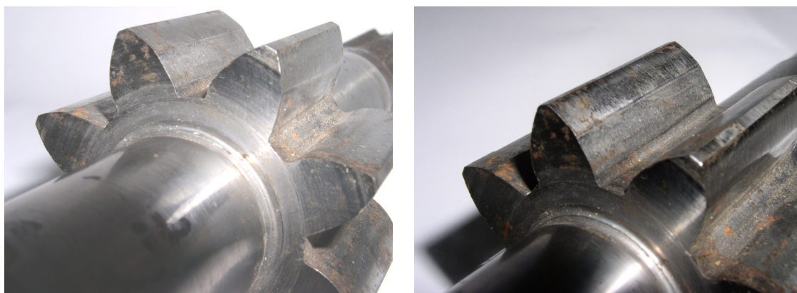
Рис. 16.20. Характер зношення евольвентного профілю ведучої шестерні
