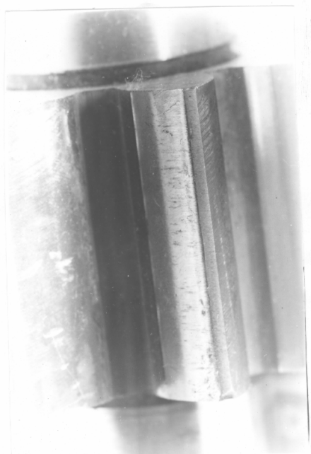
Рис. 16.21. Характер зношення евольвентного профілю веденої шестерні
