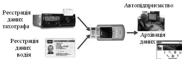
Рис. 6.13. Схема використання даних у системі транспортного моніторингу
