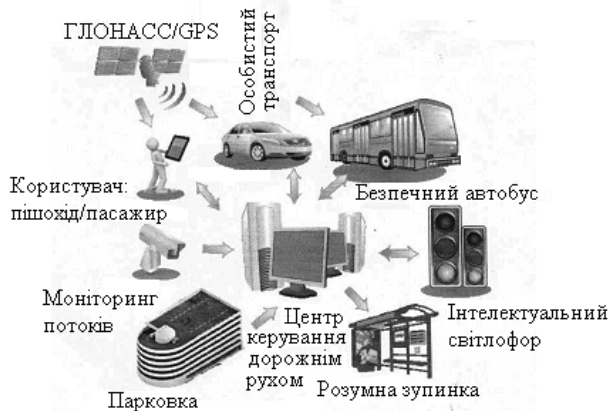
Рис. 6.27. Схема інформаційних потоків в інтелектуальних системах керування міським пасажирським транспортом
