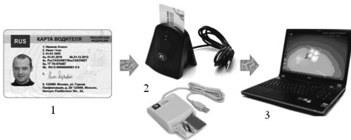
Рис. 6.16. Зчитування даних з карти з допомогою рідера:
