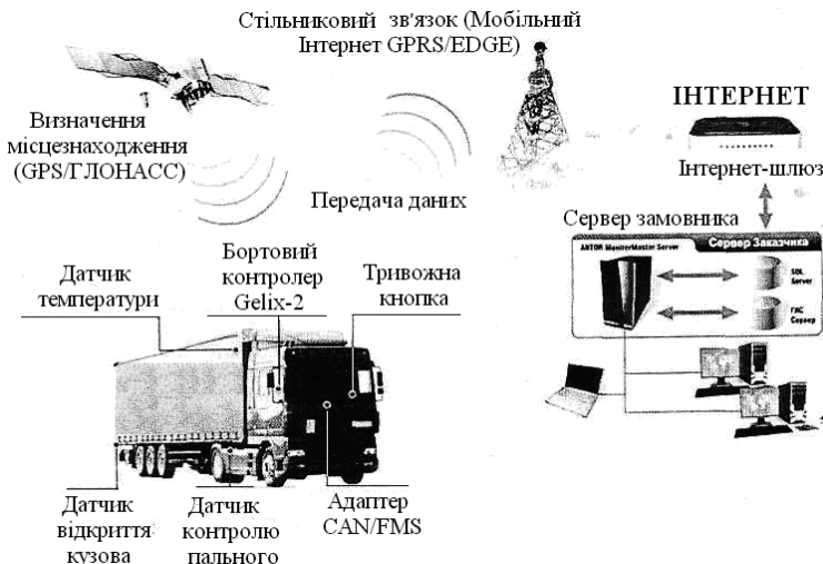
Рис. 6.23. Загальна структура трекінгових систем реального часу
