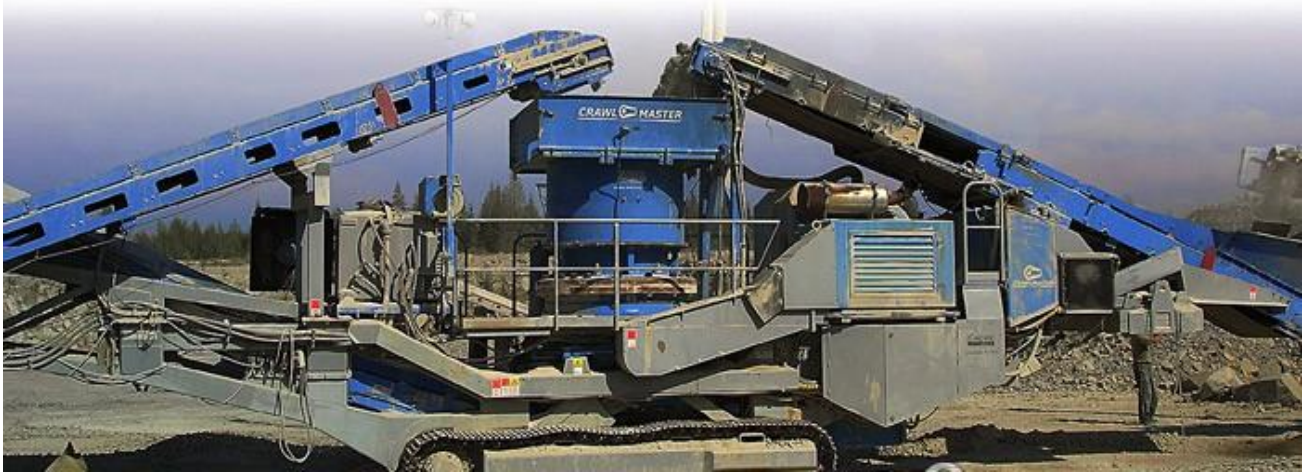
Рис. 1.1. Мобільна установка дроблення і грохочення
