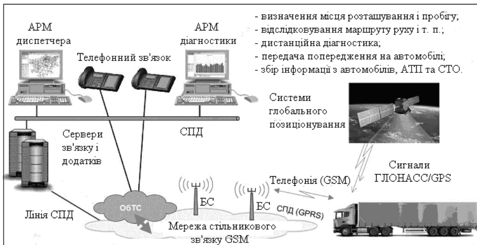
Рис. 5.19. Спрощена схема моніторингу транспортних засобів:
