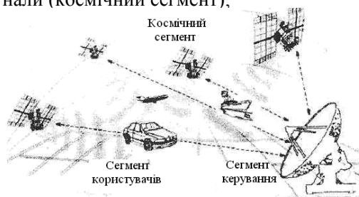
Рис. 5.2. Загальна схема структури супутникової навігаційної системи
