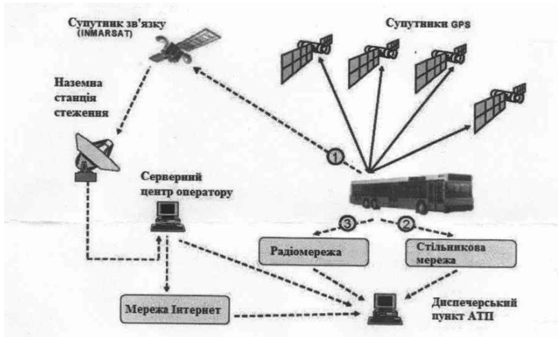
Рис. 5.9. Схема роботи диспетчерської навігаційної системи з варіантами передачі даних про місцезнаходження транспортного засобу
